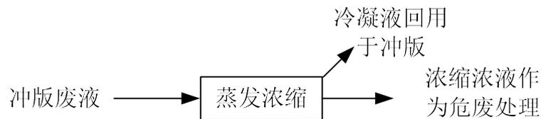
图 5 废液处理流程图
